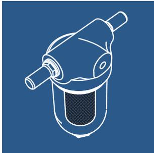
Dieser Filter ist sehr vielseitig anwendbar. Seine Konstruktion ermöglicht, zylindrische Siebe mit verschiedenen Maschenweiten einzusetzen, um Fremdkörper aus dem angesaugten Medium (Wasser, Kraftstoffe usw.) zurückzuhalten. Der durchsichtige, stoßsichere Außenbehälter läßt die zurückgehaltenen Fremdkörper gut erkennen und ist mit wenigen Handgriffen schnell zu reinigen.
